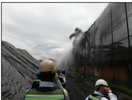
Ilustración 7. Evidencias de la puesta en funcionamiento sistema de humectación en los patios de carbón.
